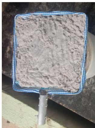
Figura 2. 1: Lodo coletado na superfície do flotor por ar dissolvido de tratamento físico-químico em uma Estação de Tratamento de Efluente Cosmético.
